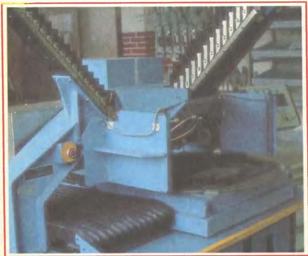
Автомат для установки микросхем «Amistar» На 1-й стороне обложки фрагмент компьютерного класса типа «Абакус».
